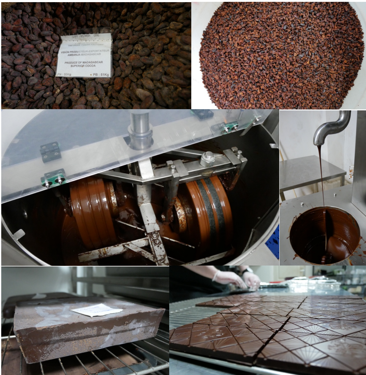
Photos 27-28-29-30-31-32 : (27) cacao marchand (28) grué après la décortiqueuse (29) concheuse (30) tempéreuse (31) masse de chocolat stocké (32) tablette moulée.
